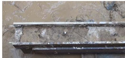
写真3. 杭用極厚H型鋼
