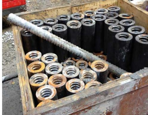
写真 3.  $\phi 57$  mm 鋼棒とカップラー
